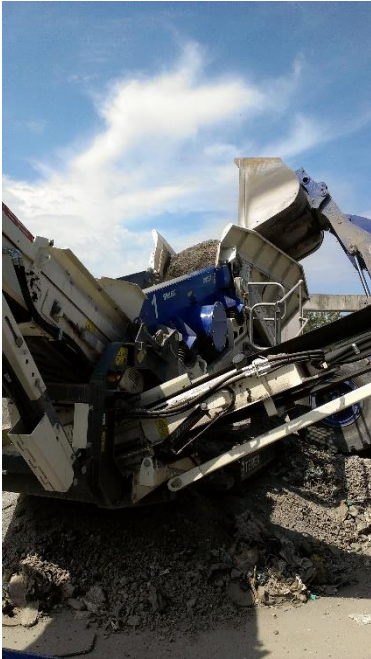
Figure 6 : alimentation de l'unité et séparation granulométrique
